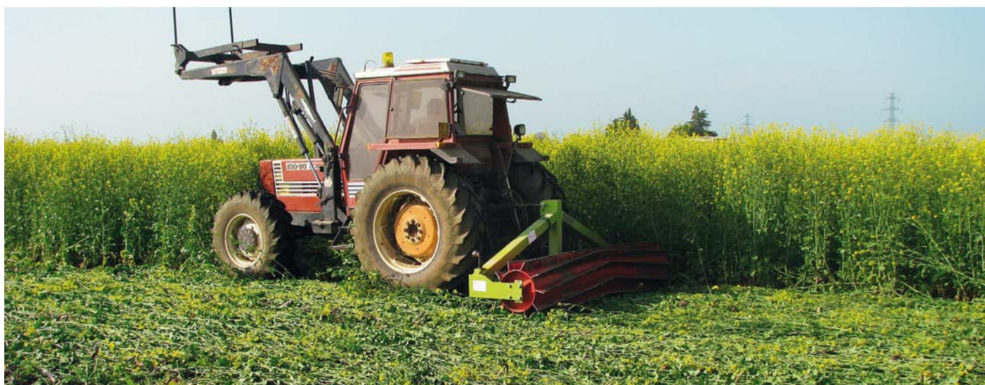
Foto 1 Terminazione di cover con senape bruna e facelia per mezzo di roller crimper
