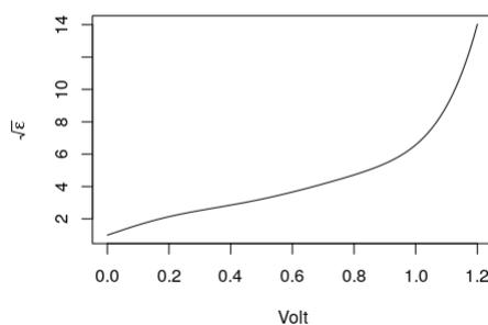
Figura 5.22: *La relazione polinomiale valida per il sensore attivo ML3, che lega l'indice di rifrazione al volume di acqua contenuta in un mezzo.*
