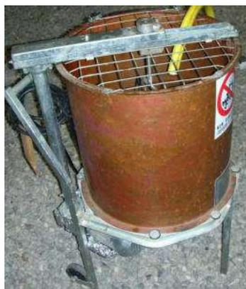
Figura 10.2: *Esempio di dinamizzatore meccanico*
