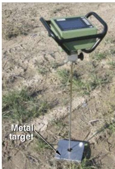
Figura 7.5: Esempio di penetrometro
