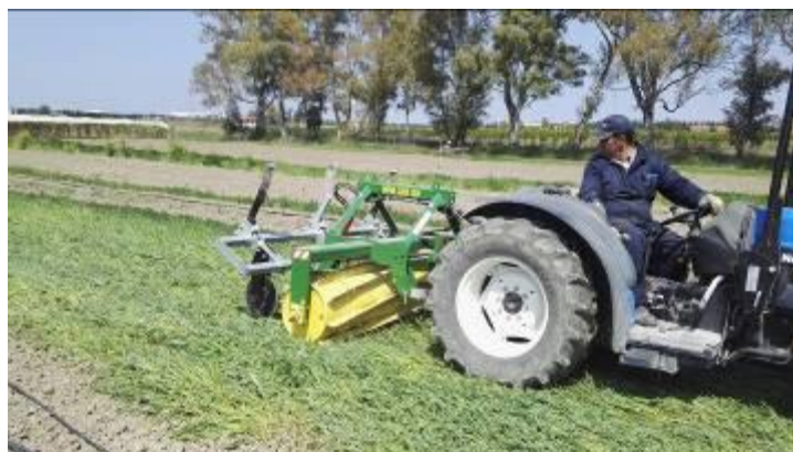
Figura 3. Allettamento (12/04/2017) delle colture di servizio agro-ecologico con l'utilizzo del "roller crimper"
