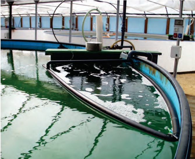
Fig. WP1.2.2.4 Porzione dell'ossigenatore ('schiumatore') destinata a convogliare la schiuma formata dal violento gorgogliamento dell'aria in un cestello raccogliitore da dove viene rimossa manualmente.
