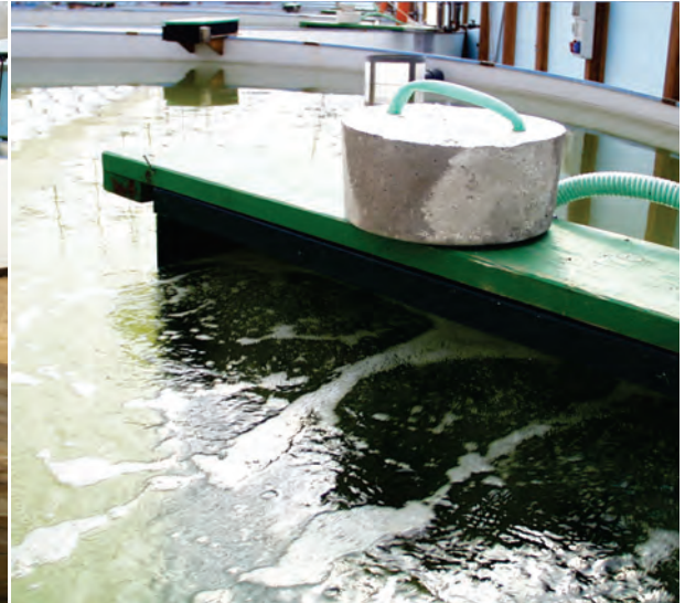
Fig. WP4.1.2.2.5 Particolare della porzione superiore dell'ossigenatore ('aeratore'), priva dello schiumatore.
