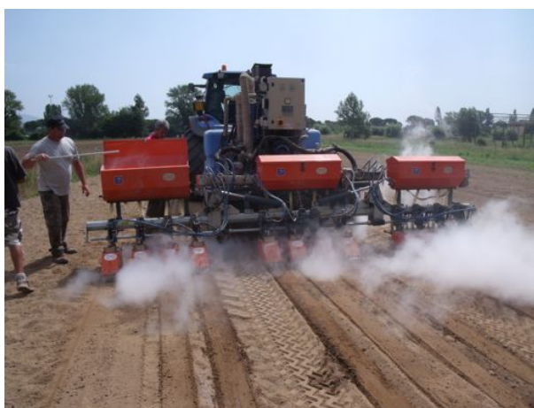
Figura 35. Macchina per il band-steaming durante il trattamento a San Piero a Grado (PI).
