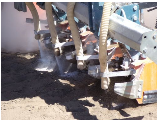
Figura 5. Particolare del sistema di distribuzione della calce che per caduta raggiunge il terreno e viene incorporata nello stesso dalle zappette rotative presenti nei carter. Come è possibile notare da questa fotografia la quantità di calce che scende dai condotti non è omogenea.
