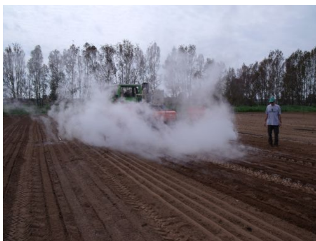
Figura 6. Fotografia esemplificativa della notevole quantità di vapore che invece di essere incorporata nel terreno è dispersa.
