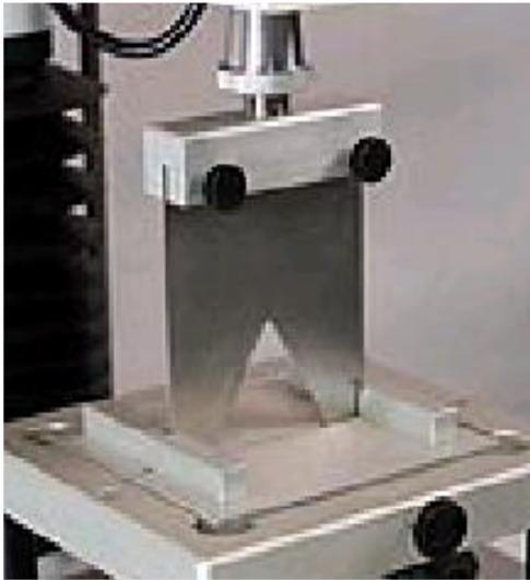
**Figura 4.** Probe per la misura della resistenza al taglio sui campioni di filetti del pesce crudo, spessore 1 mm, apertura taglio 6 cm.
