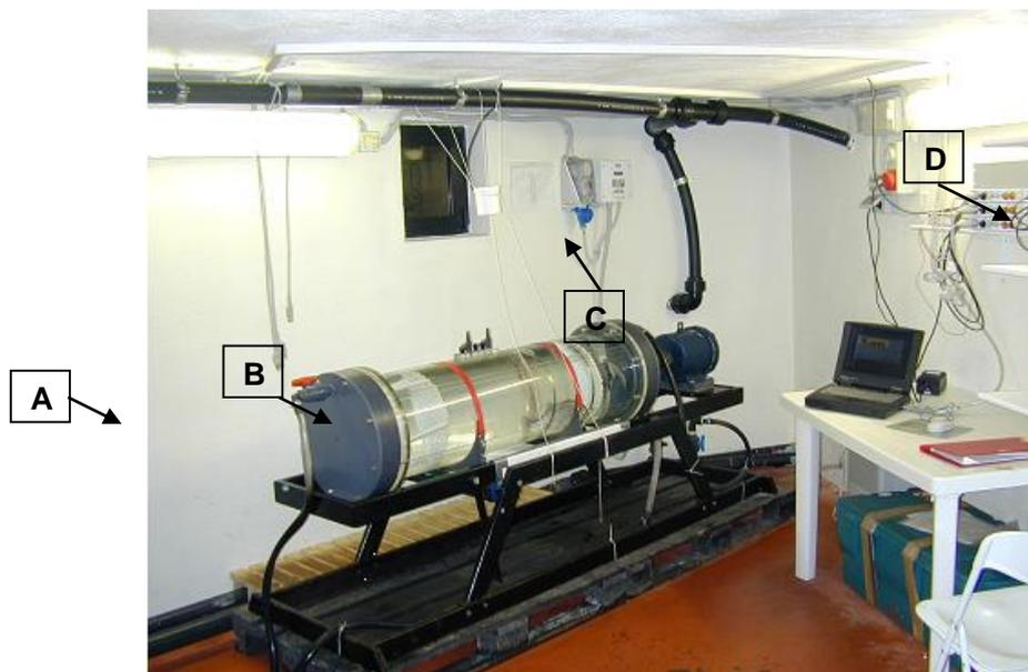
**Figura 3.** Laboratorio di telemetria presso la COISPA Tecnologia & Ricerca (BA). A: Terminali per le connessioni dei wire; B: Camera di nuoto di Blažka; C: Centralina elettrica; D: Amplificatore
