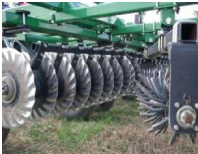
Figura 5.2: Esempio di disco ondulato tangenziale per vertical tillage. Fonte immagine: www.lifehelpsoil.eu
