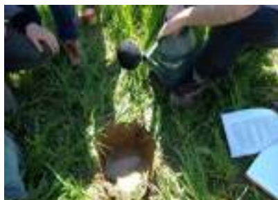
Figura 2 La soluzione di senape viene versata nel foro e viene misurata l'infiltrazione. Foto: D. Antichi
