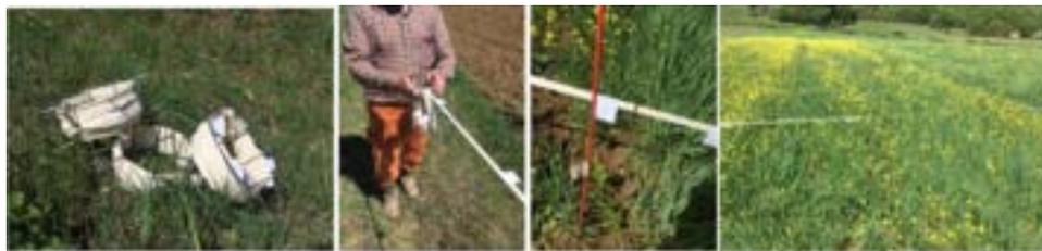
Figura 1.1: *L'individuazione dei punti di campionamento è stata fatta mediante fettucce sulle quali sono state riportate etichette con le coordinate X e Y dei punti prima determinati con apposito pacchetto geostatistico [6].*
