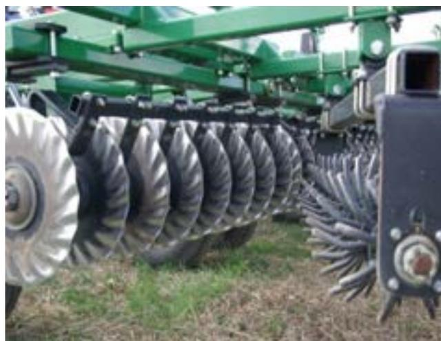
Figura 5.2: *Esempio di disco ondulato tangenziale per vertical tillage. Fonte immagine: [www.lifehelpsoil.eu](http://www.lifehelpsoil.eu)*
