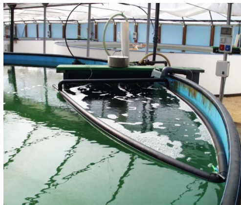
Fig. 5 Porzione dell'ossigenatore ('schiumatore') destinata a convogliare la schiuma formata dal violento gorgogliamento dell'aria in un cestello raccoglitore da dove viene rimossa manualmente.
