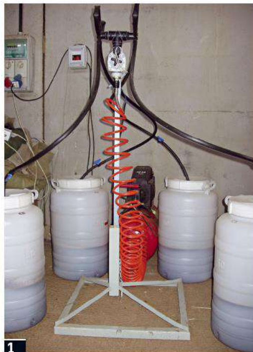
Foto A Processo di estrazione del compost-tea: (1) impianto di estrazione simultanea con quattro fermentatori; (2) sacca di tessuto-non-tessuto contenente compost; (3) fase di aerazione; (4) apertura del fermentatore a processo concluso; (5) recupero del compost-tea
