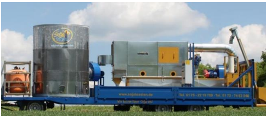
Figure 1: Mobile toaster – Möhler Technik. Source: Möhler Technik, https://mobilersojatoaster.de
