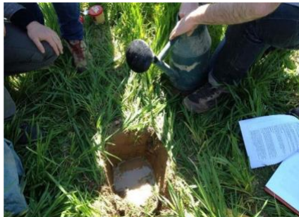
Figura 2 La soluzione di senape viene versata nel foro e viene misurata l'infiltrazione. Foto: D. Antichi
