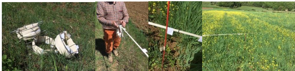
Figura 1 L'individuazione dei punti di campionamento è stata fatta mediante fettucce sulle quali sono state riportate etichette con le coordinate X e Y dei punti prima determinati con apposito pacchetto geostatistico (Bivand et al., 2020).
