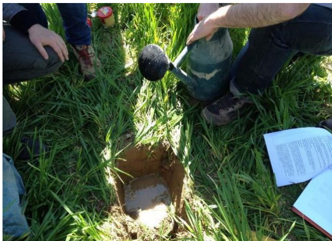
Figura 27 La soluzione di senape viene versata nel foro e viene misurata l'infiltrazione. Foto: D. Antichi
