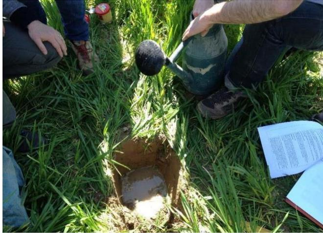
Figura 67 La soluzione di senape viene versata nel foro e viene misurata l'infiltrazione. Foto: D. Antichi
