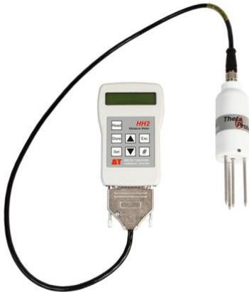
Figura 46 Igrometro con sonda ML3 per la misura dell'umidità volumetrica del suolo volumetrico ( $m^3m^{-3}$ ). Vista l'eterogeneità dei terreni, è possibile impostare il computer associato al campionamento di diversi suoli, tarandolo per 5 terreni che saranno mantenuti poi in memoria contemporaneamente.
