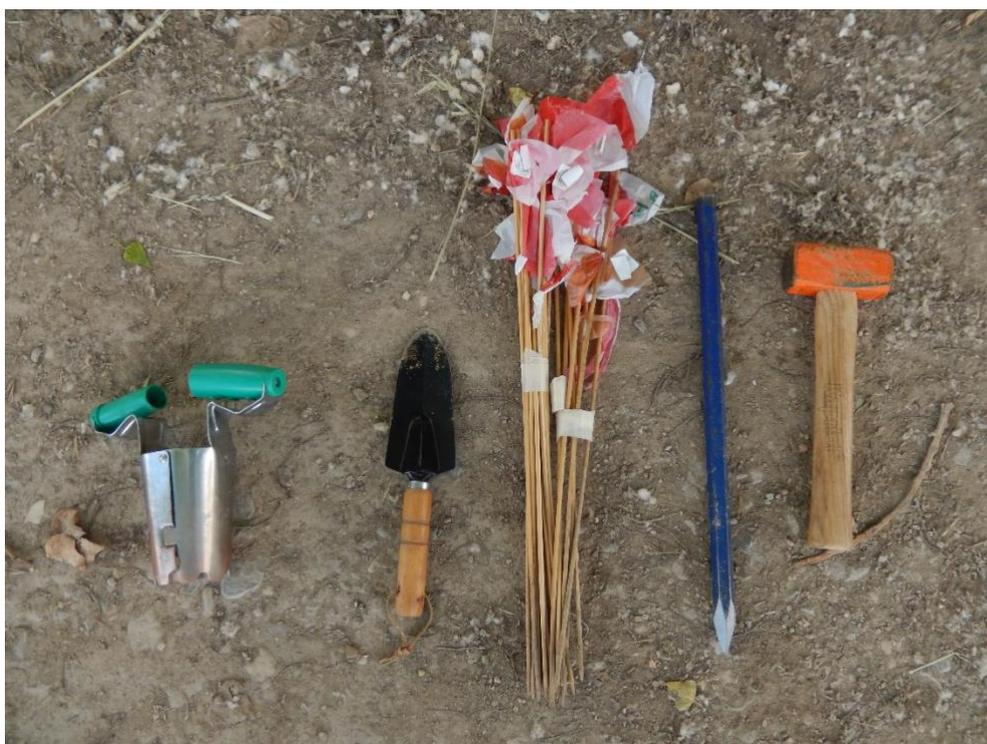
Figura 19 Strumenti utilizzati per il collocamento delle trappole
