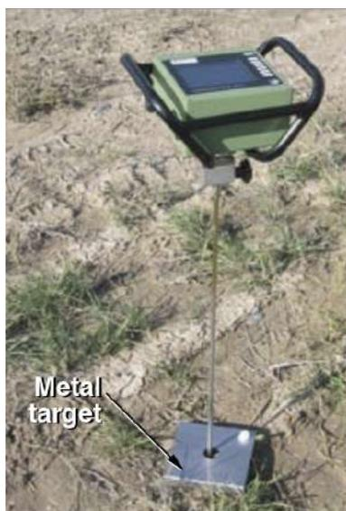
Figura 7.5: Esempio di penetrometro
