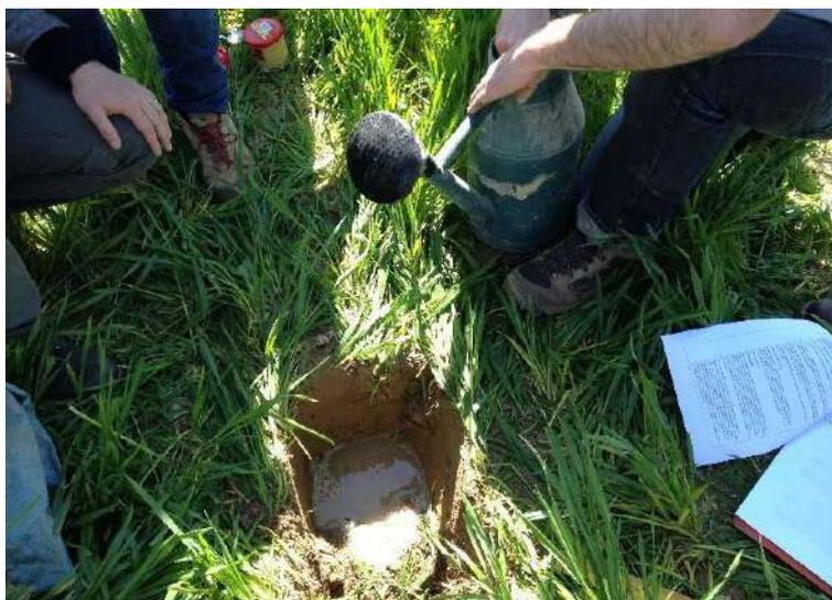
Figura 7.2: *La soluzione di senape viene versata nel foro e viene misurata l'infiltrazione. Foto: D. Antichi*
