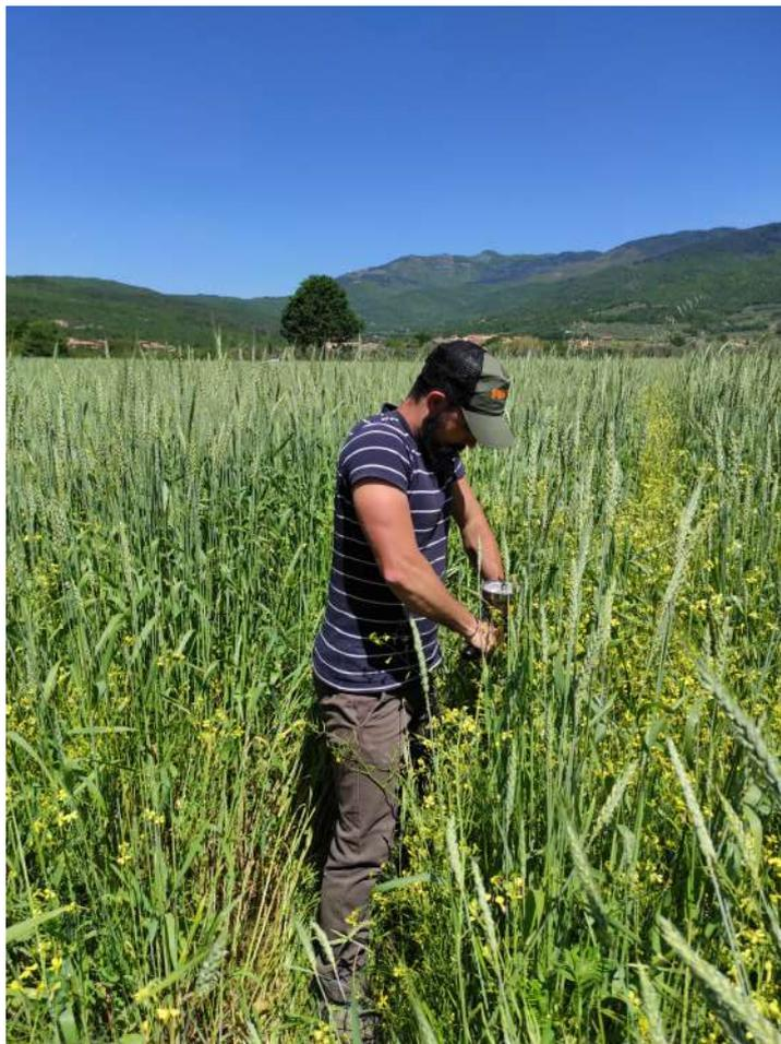
Figura 2.27: *Misura della resistenza alla penetrazione presso l'Azienda Agricola Tommaso Romualdi*
