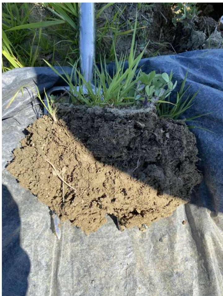
Figura 2.4: *Test della vanga presso l'Azienda Agricola Bianca Mascagni*
