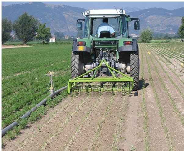
Fig. 1 - Sarchiatura di radicchio bio con erpice a dischi attivi (Università di Pisa)
