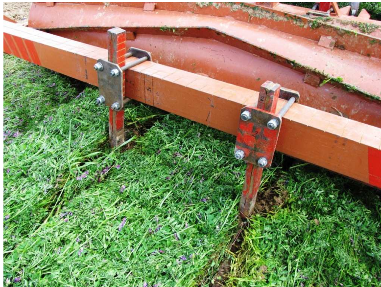
Figura 10. Attrezzo per l'allettamento delle colture di copertura e preparazione del letto di trapianto (particolare dei discissori posteriori)
