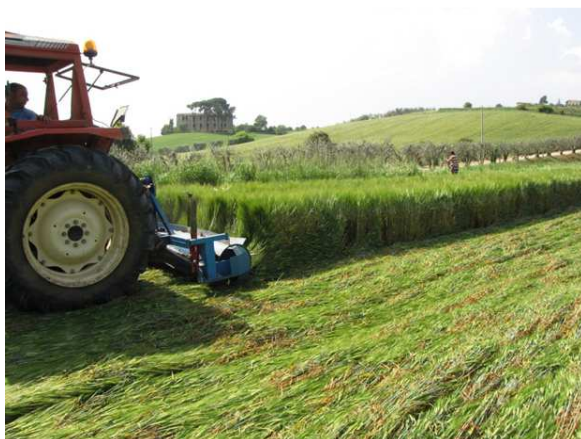
Figura 4. Allettamento dell'orzo mediante roller crimper. Monsampolo del Tronto. CRA – ORA.
