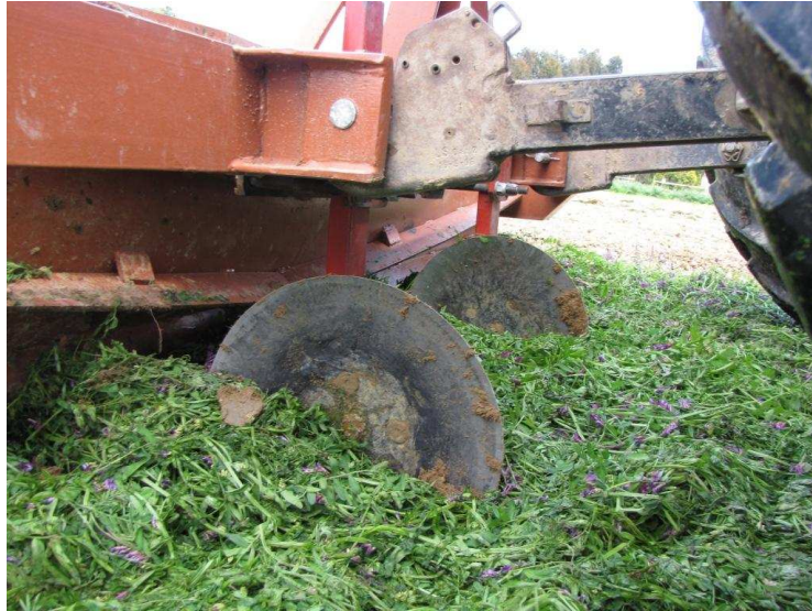
Figura 10. Attrezzo per l'allettamento delle colture di copertura e preparazione del letto di trapianto (particolare dei dischi anteriori)
