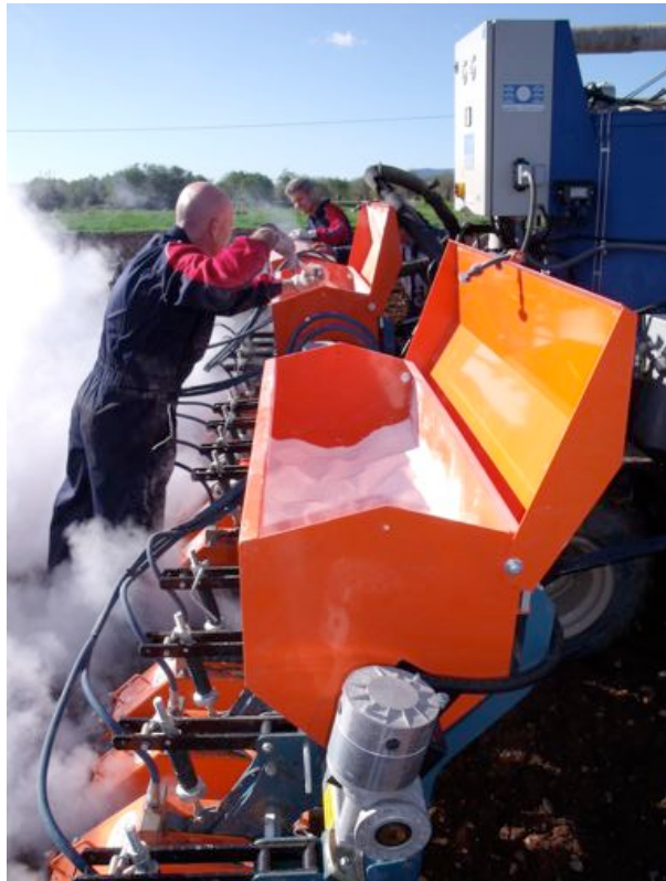
Fig.3. Tramogge dell'operatrice per trattamenti con vapore in banda.
