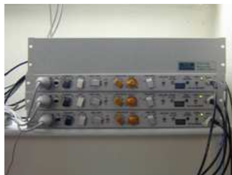
Figura WP3.5 Dettaglio dell'amplificatore GRAS per il segnale elettromiografico.
