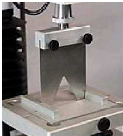
Figura WP6.1 Probe per la misura della resistenza al taglio sui campioni di filetti del pesce crudo, spessore 1 mm, apertura taglio 6 cm.
