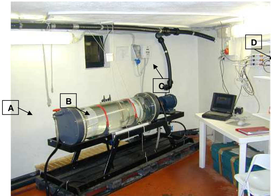
Figura WP3. 4 Laboratorio di telemetria presso la COISPA Tecnologia & Ricerca (BA). A: Terminali per le connessioni dei wire; B: Camera di nuoto di Blažka; C: Centralina elettrica; D: Amplificatore
