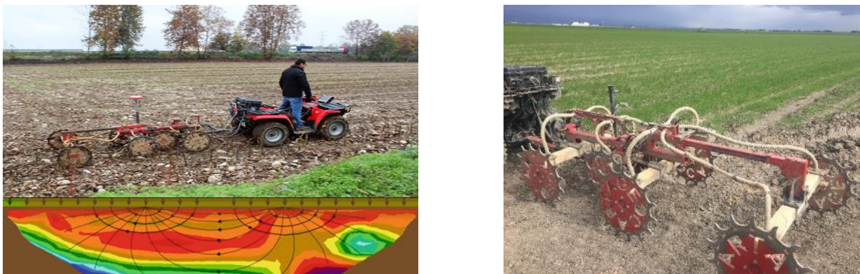
Fig. 10 – Sistema di acquisizione dei valori geoelettrici da sviluppare presso alcuni dei campi individuati per la sperimentazione della campagna di coltivazione 2019/2020.
