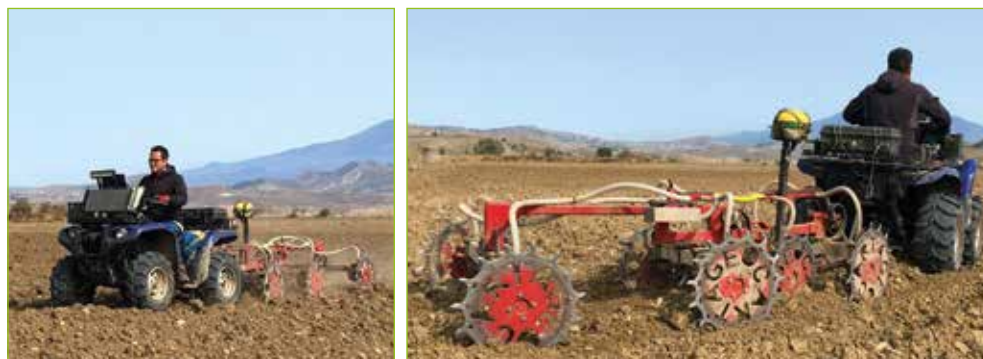
Fig. 4.1 - Carrello a tre assi per la mappatura geoelettrica
