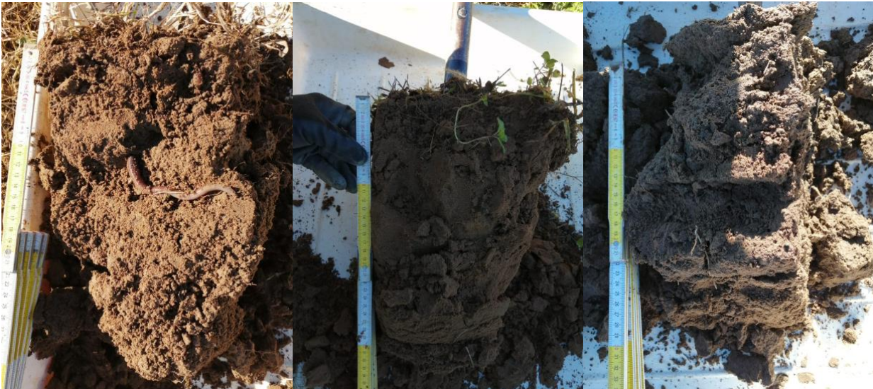
Figura 25 – Profili di prova della vanga su PER (sinistra), RED (centro) e ORG (destra)
