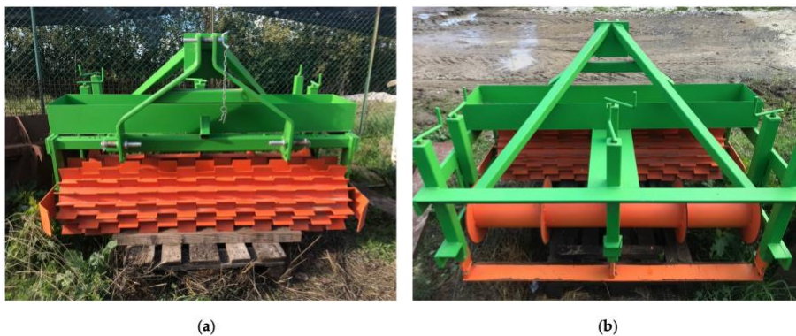
Fig.26 – Prototipo di rullo con lama per la devitalizzazione delle colture di copertura: (a) vista frontale; (b) vista posteriore.
