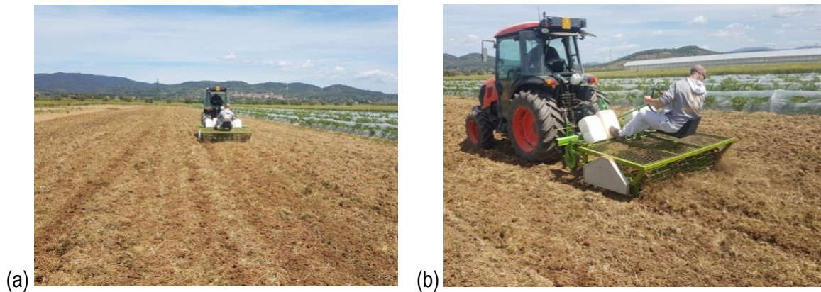
Fig.12 – (a) Primo intervento di falsa semina con erpice a dischi attivi dopo la rottura della crosta superficiale e l'affinamento del terreno ottenuto mediante un passaggio con erpice rotante nell'itinerario tecnico innovativo; (b) particolare degli organi lavoranti dell'erpice a dischi attivi.
