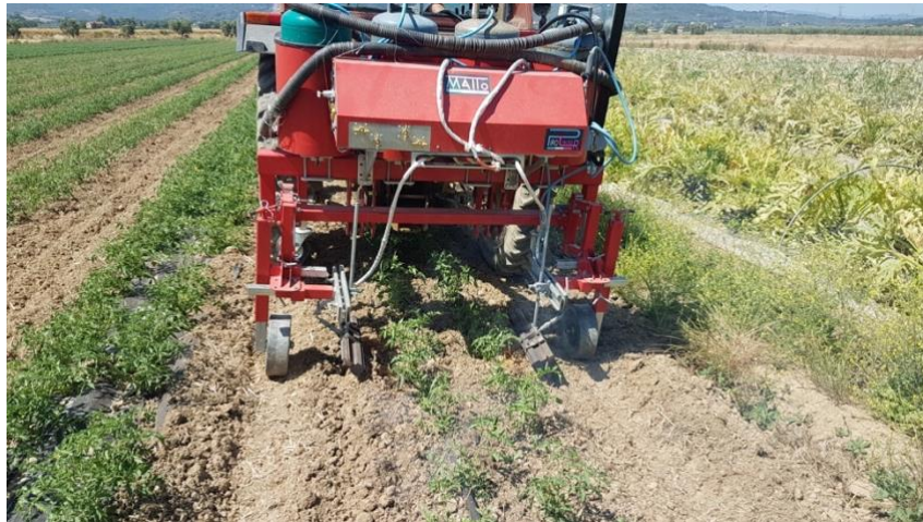
Fig.17 - Operatrice per il pirodiserbo a fiamma libera allestita per il trattamento di "side flaming" in fase di lavoro su alcune parcelle in cui è stato adottato l'itinerario tecnico innovativo 2.
