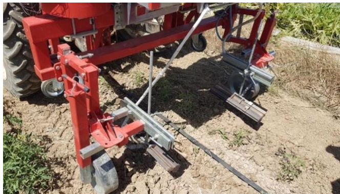
Fig.18 - Particolare del bruciatore prismatico dell'operatrice per il pirodiserbo a fiamma libera per il controllo termico selettivo delle infestanti presenti sulle due file che compongono la bina.
