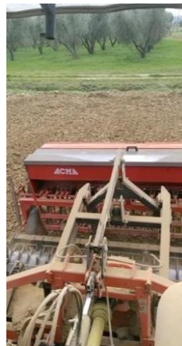
Fig.9 – Semina della cover crop con seminatrice meccanica associata a erpice rotante nell'itinerario tecnico innovativo.
