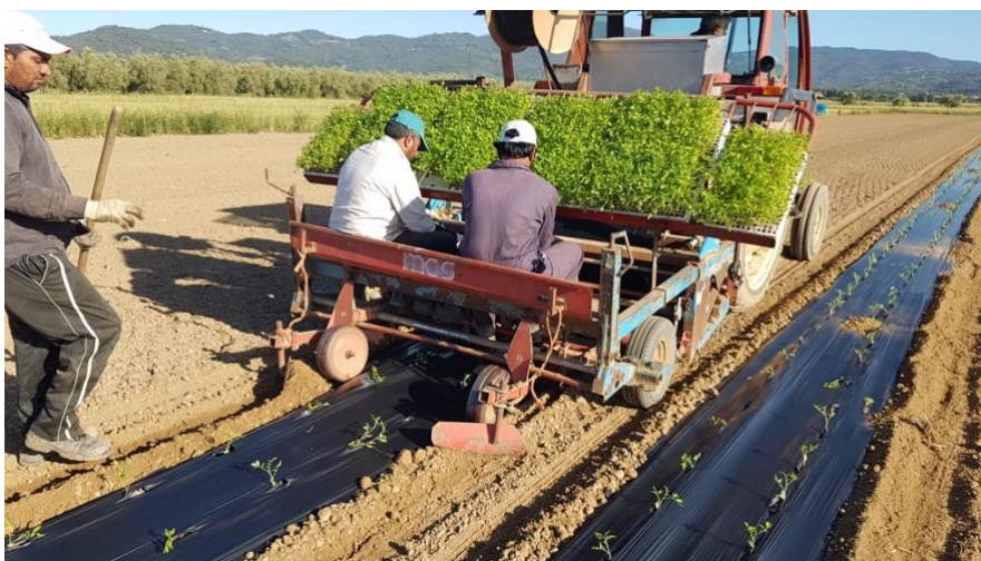
Fig.6 – Trapianto del pomodoro con contemporanea stesura della manichetta per l'irrigazione e del biotelo nell'itinerario tecnico aziendale.
