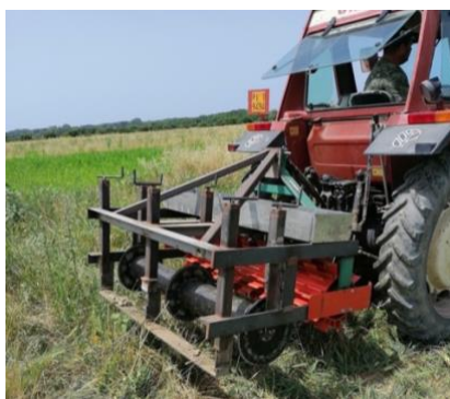
Fig.26 – Prototipo di rullo con lama per la devitalizzazione delle colture di copertura.
