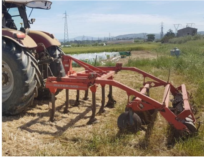
Fig.8 – Coltivatore combinato utilizzato per la lavorazione ridotta del terreno e per l'interramento della cover crop nell'itinerario tecnico innovativo.
