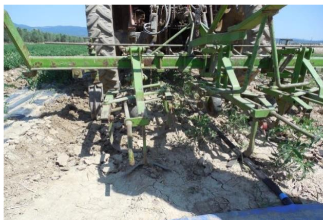
Fig.15 - Particolare degli utensili di cui era equipaggiata la sarchiatrice di precisione durante il secondo intervento effettuato nell'ambito dell'itinerario tecnico innovativo.
