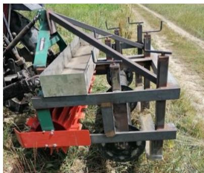
Fig.27 - Prototipo di rullo con lama per la devitalizzazione delle colture di copertura. Notare la tramoggia creata per zavorrare la macchina.
