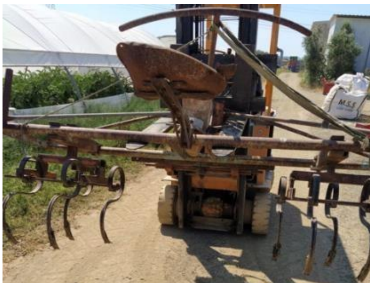
Fig.7 – Sarchiatrice "artigianale" realizzata in azienda per la lavorazione con controllo meccanico delle infestanti nello spazio tra le bine nell'itinerario tecnico aziendale.
