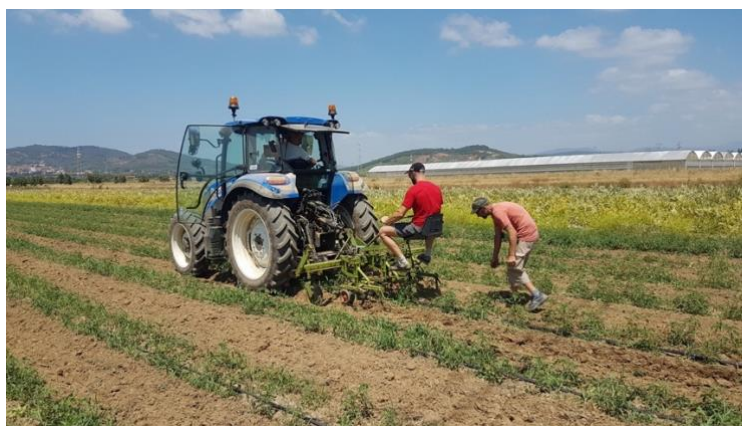
Fig.14 - Sarchiatrice di precisione in fase di lavoro durante la prima sarchiatura prevista dall'itinerario tecnico innovativo.
