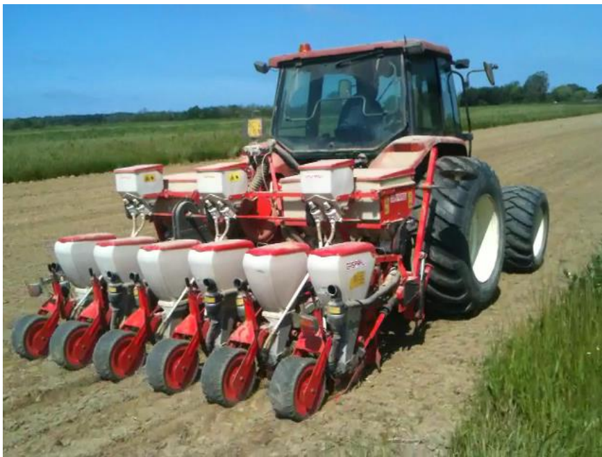
Figura 9 – Semina del mais e del girasole con seminatrice di precisione da sodo sui campi del sistema biologico. L'uso della seminatrice da sodo, dotata di dischi metallici in grado di aprire il solco di semina, si rende necessario per la presenza dei residui del sovescio di veccia e orzo, interrato poche settimane prima nel sistema biologico mediante erpicatura con erpice a dischi (Maggio 2015)
